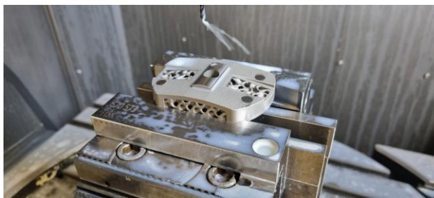
Obrázek 3 Dokončení funkčních ploch
