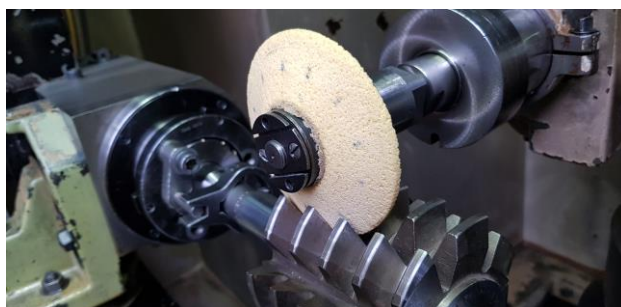
Poloha tvarového brusného nástroje s automaticky vygenerovanou geometrií v broušené drážce
